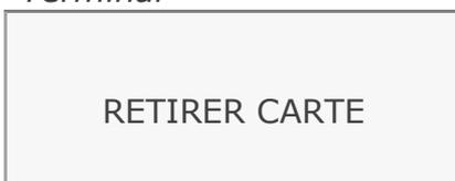
■ Si la carte sans contact est lue correctement les 4 LEDs vertes s'allument pendant 1 seconde et le terminal émet 2 bips sonores. Le système d'acceptation affiche le message invitant l'utilisateur à retirer sa carte.
